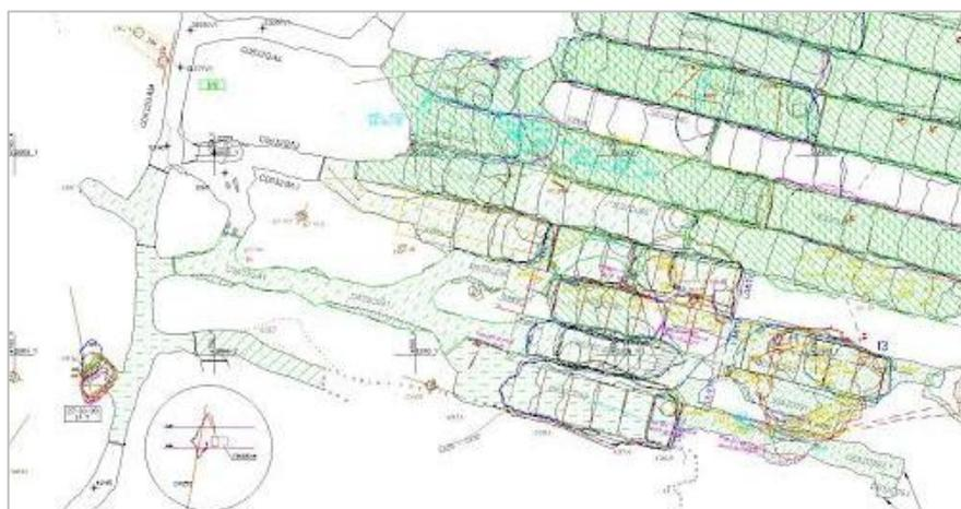
Figura 3.3 - Bancada do nível C630 da área do Corvo totalmente preenchida, com dimensão de 40 x 12 x 20 m (Fonte: SOMINCOR, 2015)
