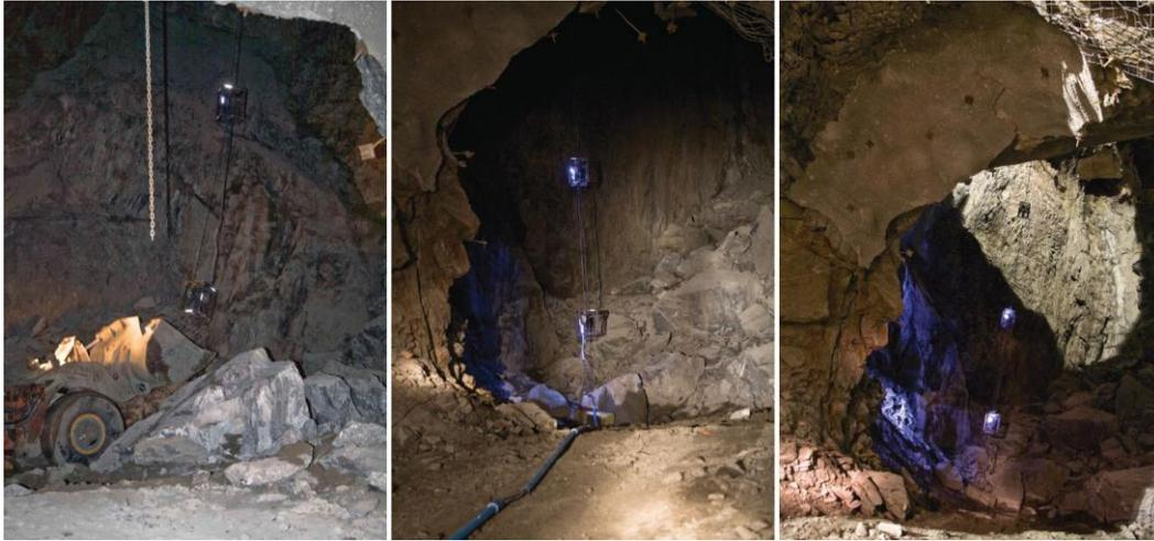
Figura 2.22 - Sistema de monitorização numa galeria preenchida, com três gaiolas situadas a uma altura de 3 m, 6 m e 9 m (adaptado de Thompson et al., 2012)
