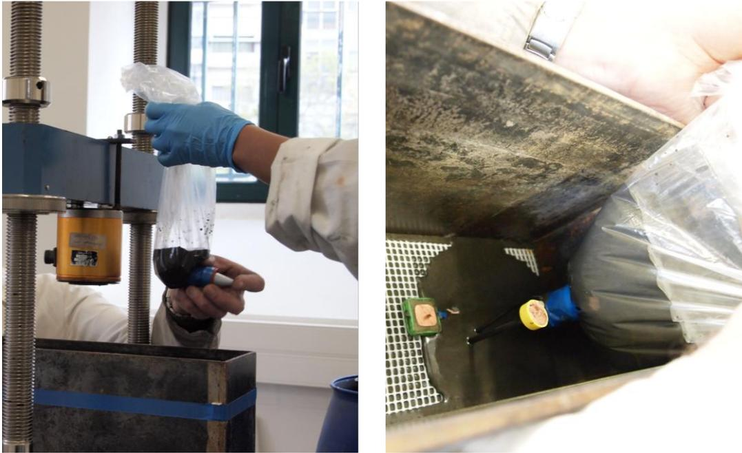
Figura 3.14 - Colocação do enchimento no interior do modelo, com caudal controlado
